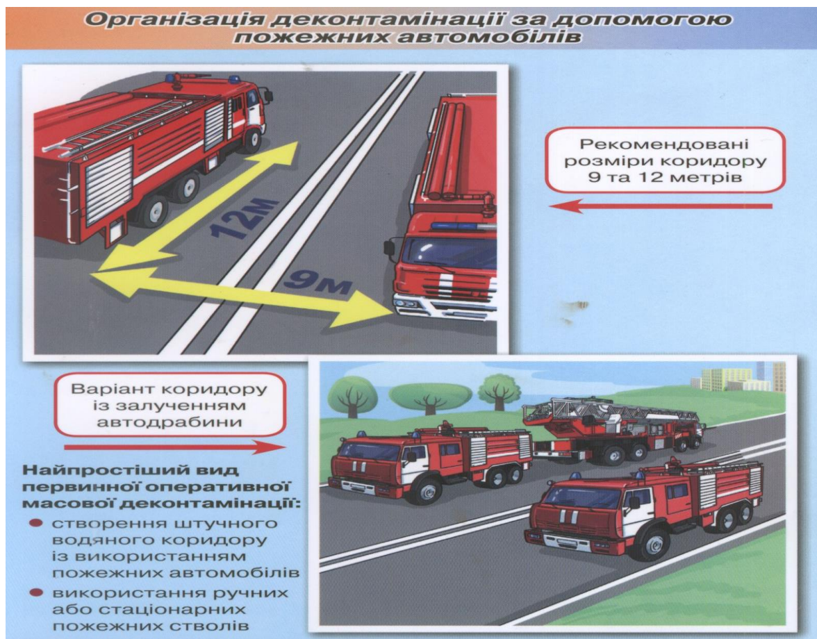
Рисунок 9. Схема розміщення пожежних автомобілів для спеціальної обробки
